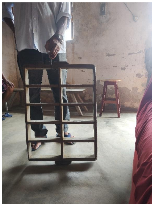
Fotografia 29. Forma de fazer tijolos, localidade Bendó
